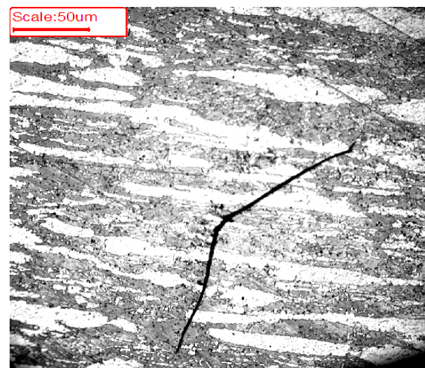
Figure IV.26 : fissure dans l'échantillon vieilli à 350°C pendant 200h
