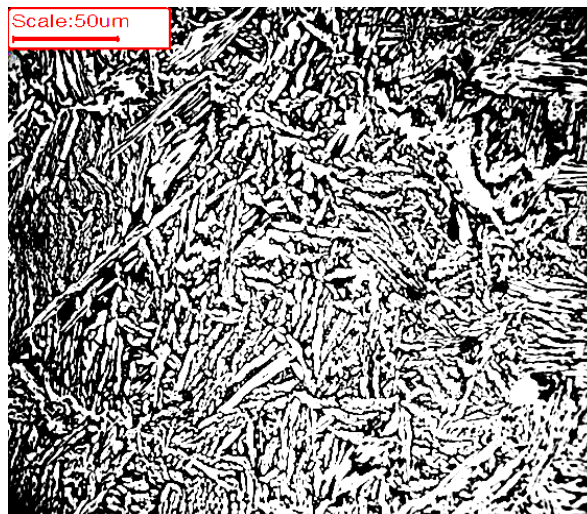
Figure IV.15 : microstructure de la zone fondue après 100h à 350°C
