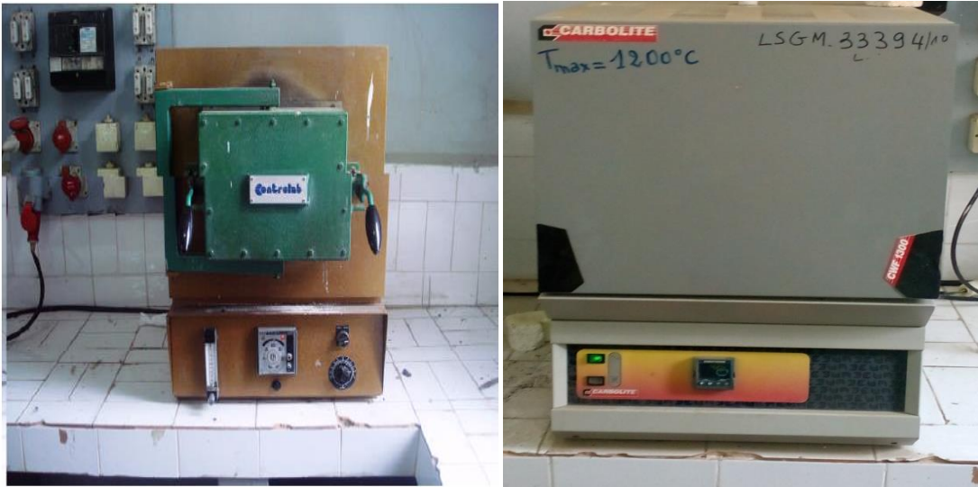
Figure III.4 : fours des traitements thermiques Tmax=1200°C
