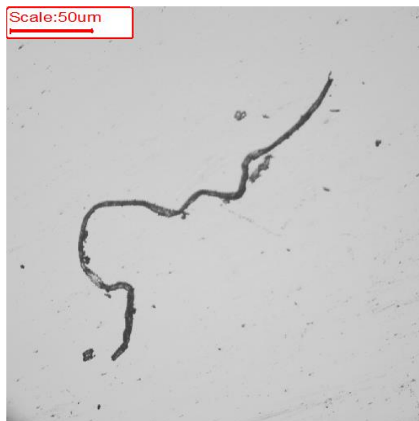
Figure IV.23 : Fissure dans un échantillon non attaqué vieilli à 320°C pendant 250h
