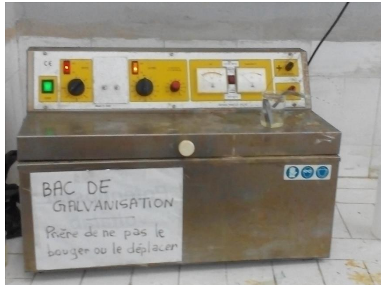
Figure III.8 : Dispositif utilisé pour l'attaque électrolytique
