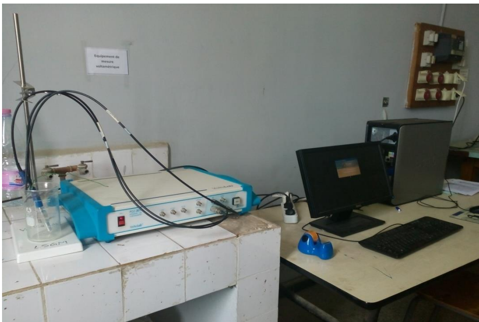
Figure III.14: potentiostat utilisés pour l'étude électrolytique
