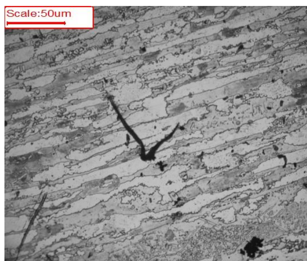
Figure IV.21 : Fissure dans l'échantillon vieilli à 320°C pendant 100h
