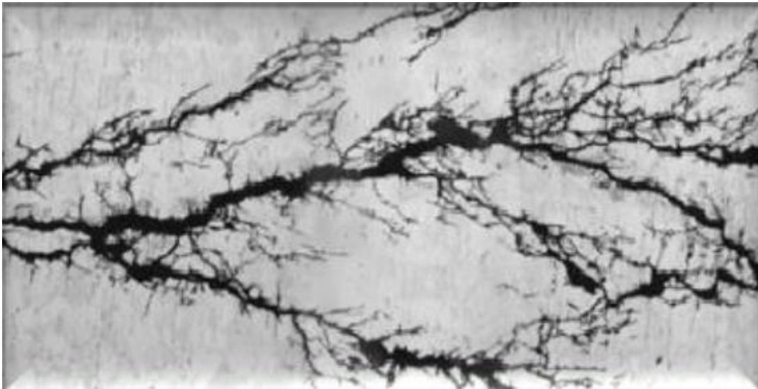
Figure II.9 :corrosion sous contraintes et propagation des fissures
