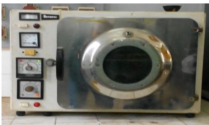
Figure III.16 : l'étuve utilisée pour la réalisation des essais de corrosion.
