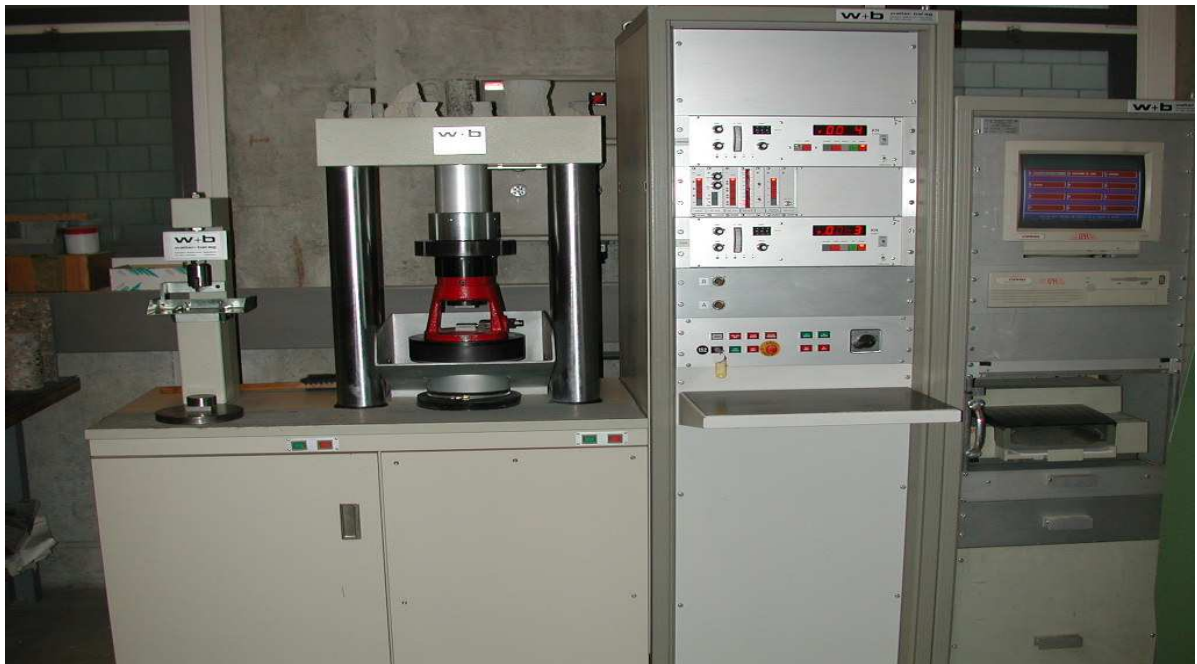
Photo N°1 : Machine Walter + bai ag CH- 8224 Löhningen type D-300-D utilisée pour les essais mécaniques.
