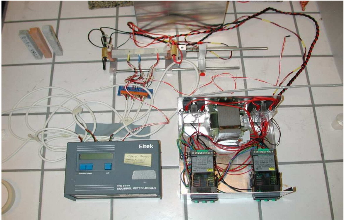
Photo N°1 : Appareillage réalisé pour la mesure de la conductivité thermique.
