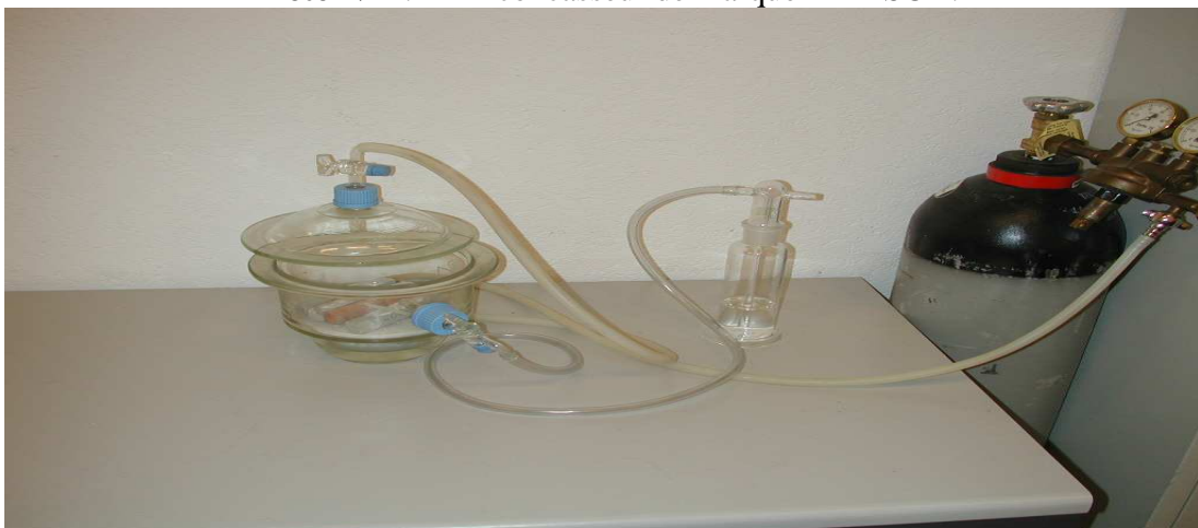
Photo N°5 : Montage de l'essai de carbonatation.
