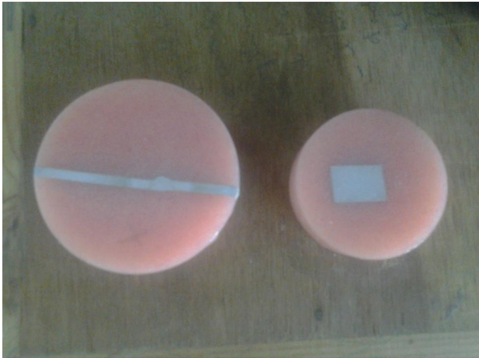
FIGURE 4.3: le cordon de soudure du 2024T3 à gauche et le métal de base à droite enrobés, polis et attaqué chimiquement
