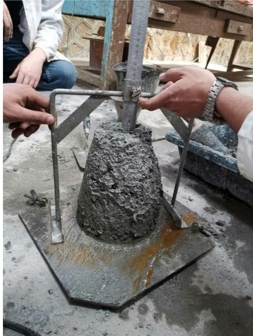
**Figure 6.2: Mesure de l'affaissement à l'aide du portique de mesure**
