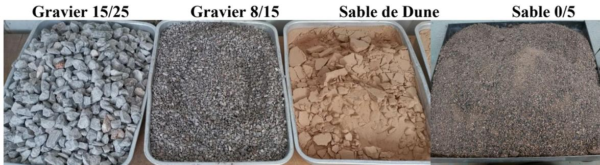
**Figure 4.2: Types de Granulats utilisés**
