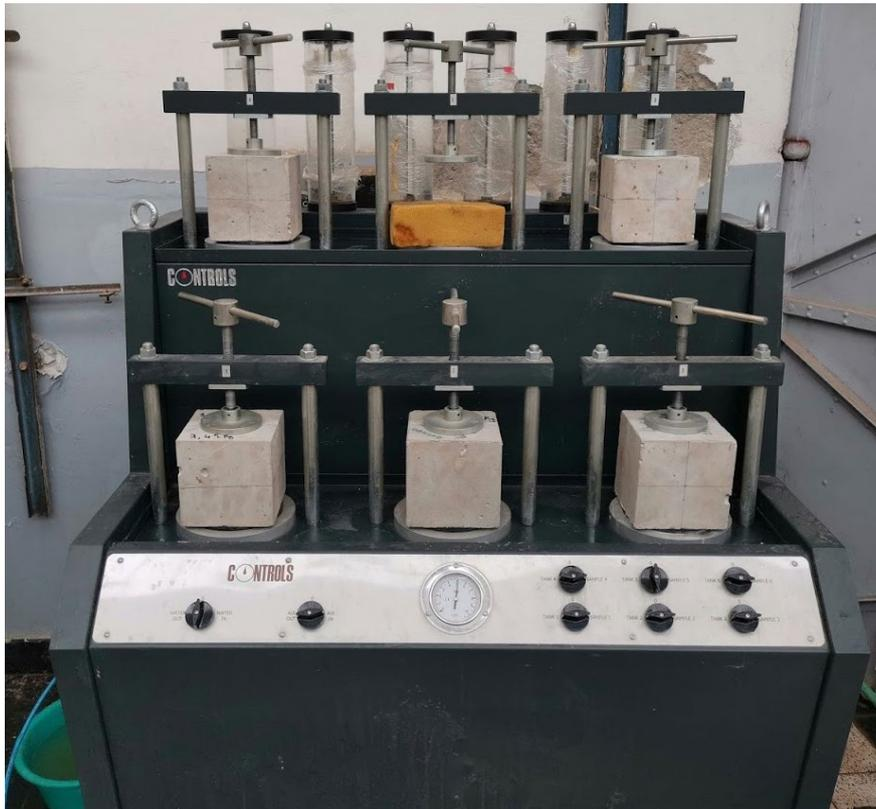
**Figure 6.5: Test de perméabilité à l'eau**
