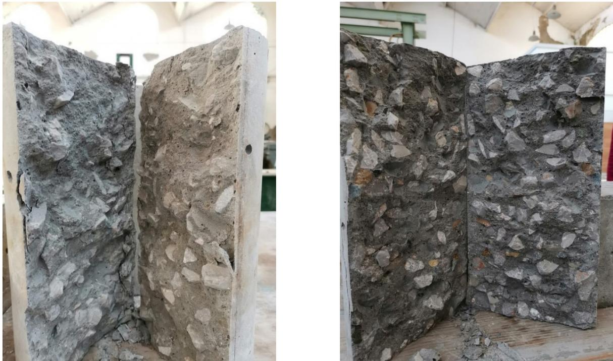
**Figure 7.3: Profils des échantillons de fendage, BPCO à gauche et BBO à droite**
