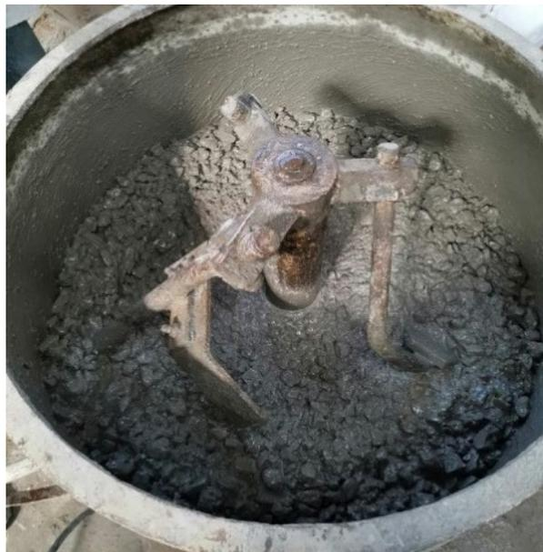
**Figure 5.2: Malaxage de matière première pour obtenir un béton**
