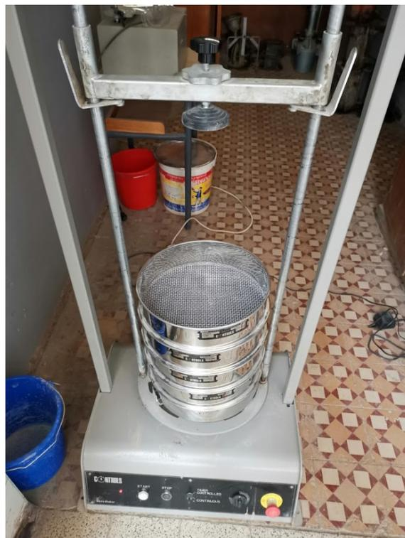
**Figure 4.3: Série des tamis installés dans une tamiseuse électrique**
