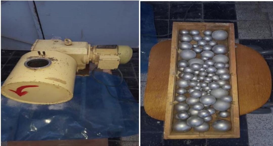
**Figure 4.8: Broyeur à boulets**
