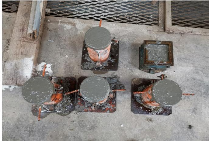
**Figure 5.3: Moules coulés par le béton**
