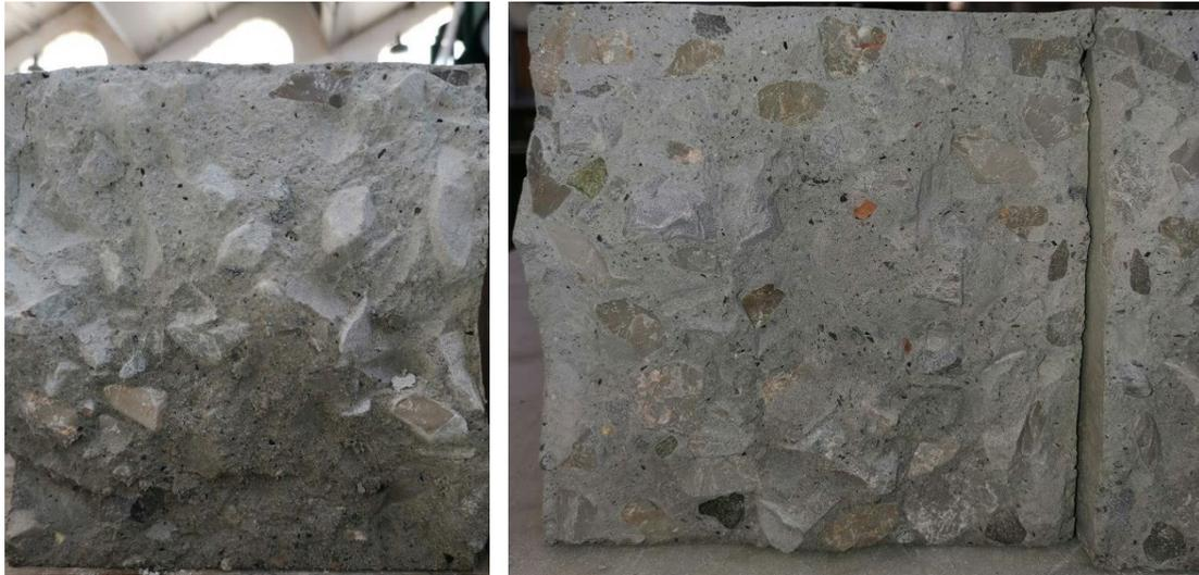
**Figure 7.6: Profils des échantillons de perméabilité ; BPCO à gauche et BBO à droite**
