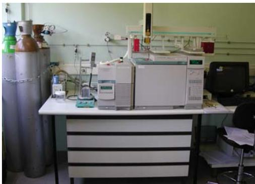
Figure V.9 : Photo chromatographie en phase gazeuse
