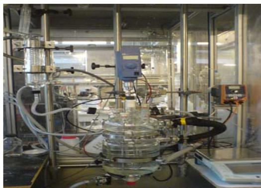
**Figure V.1** : Schéma du système expérimental (réacteur calorimétrique)
