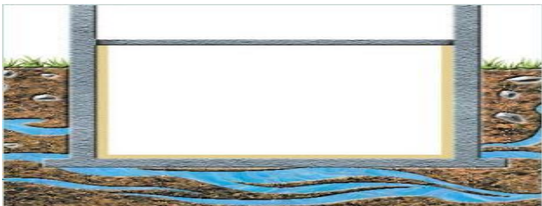
FigII.4. Nature de cuvelage ou du revêtement d'étanchéité tous dépende de la Remontée de nappe
