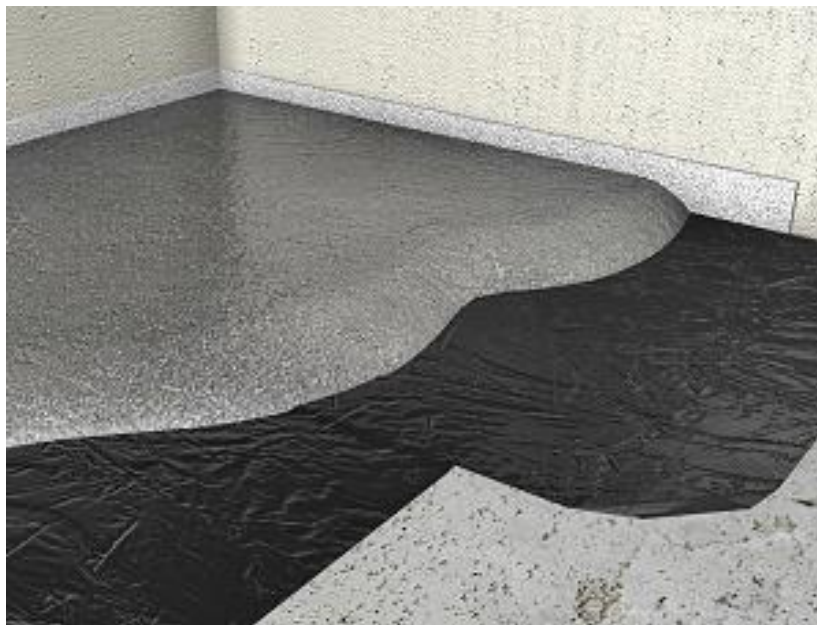
FigI.2. Revêtement épais à base de mortier.
