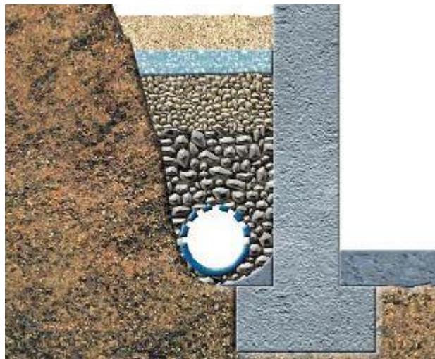
FigII.5. Solution traditionnelle de tranchée et canalisation drainante
