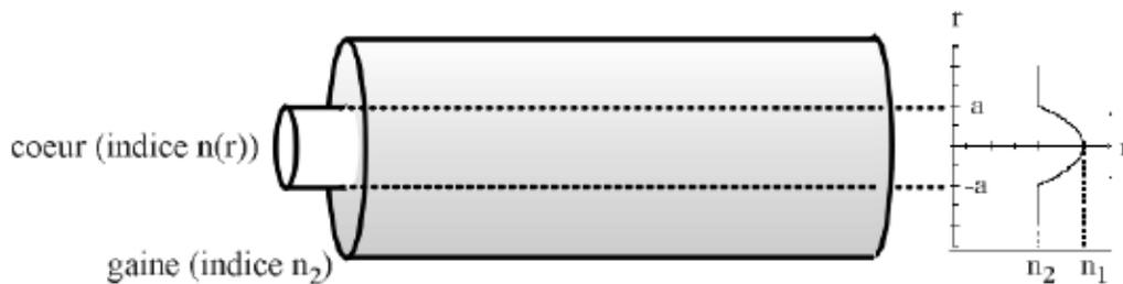
**Figure 2.6 :** Schéma d'une fibre optique multimode à gradient d'indice
