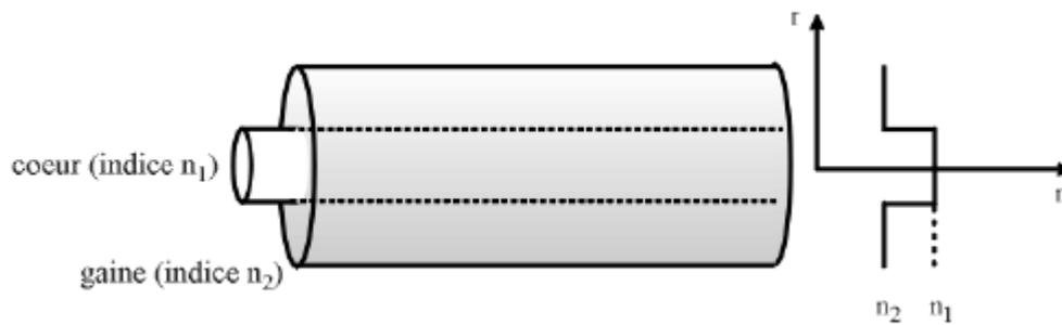
**Figure 2.4 :** Schéma d'une fibre optique multimode à saut d'indice
