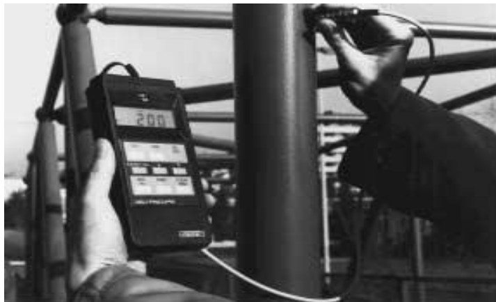
Figure III.2 : Appareil pour la mesure de l'épaisseur de peinture (epaissimetre)
