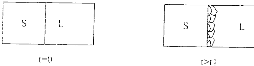
Figure II.12 : Schéma du processus de formation des phases à partir d'un liquide en fonction du temps [21].
