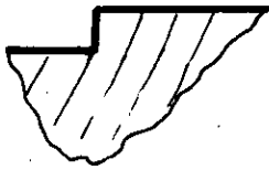
- fig 1 - Discontinuité géométrique.
