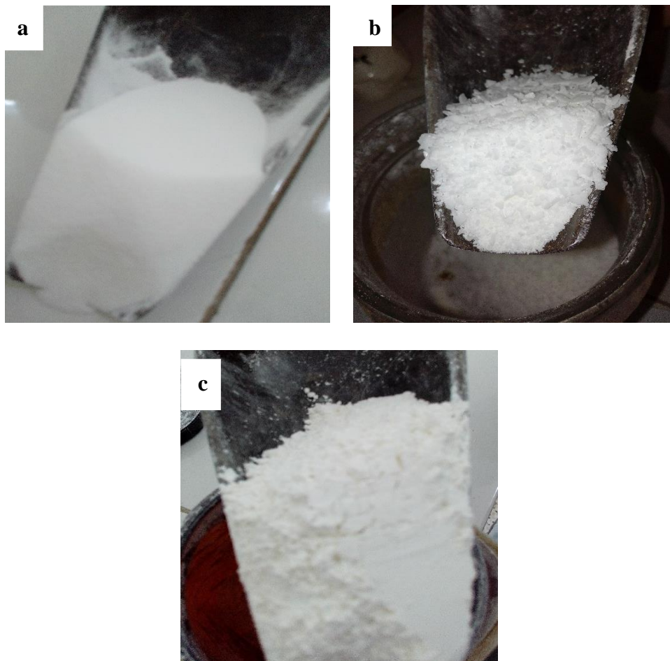
Figure 2.4 : (a) PVC, (b) Acide stéarique, (c) Stabilisant Ca/Zn
