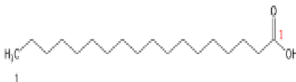
Figure 2.2 : Structure chimique de l'acide stéarique
