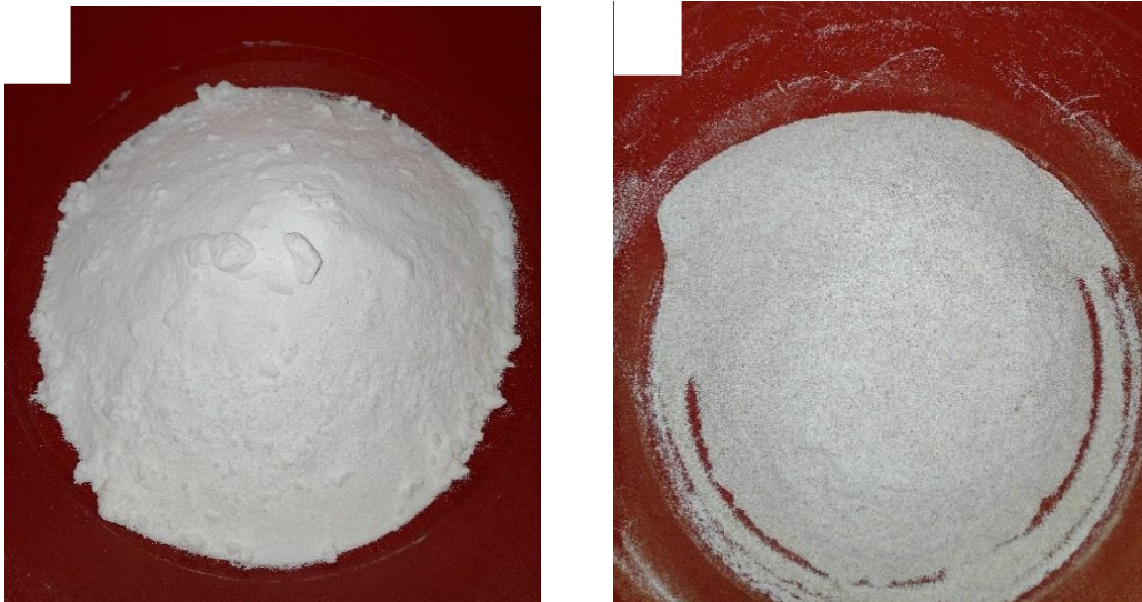
Figure 2.5 : (a) Mélange du PVC et additifs, (b) Mélange PVC/farine des noyaux de dattes
