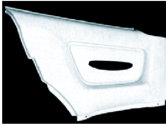
Figure 1.11 : Habillage intérieur de portière de voiture en lin/polypropylène.
