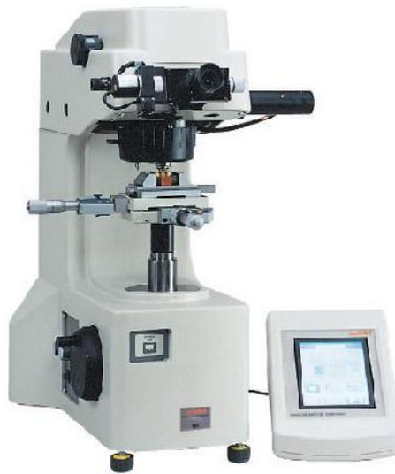
**Figure IV.9:** Machine de Micro-dureté Vickers HM-100.
