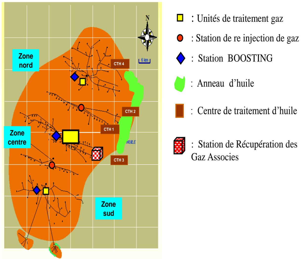
**Figure 1.3** : Répartition des différentes installations sur le champ de Hassi R'mel.
