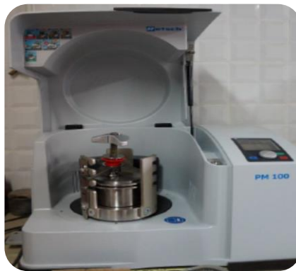
Figure 5.1 : Broyeur planétaire à billes Retsch (PM 100).
