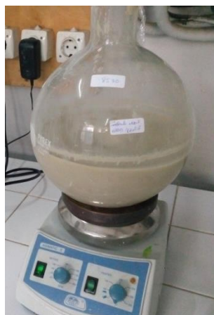
Figure 5.3 : Opération d'activation de la bentonite.
