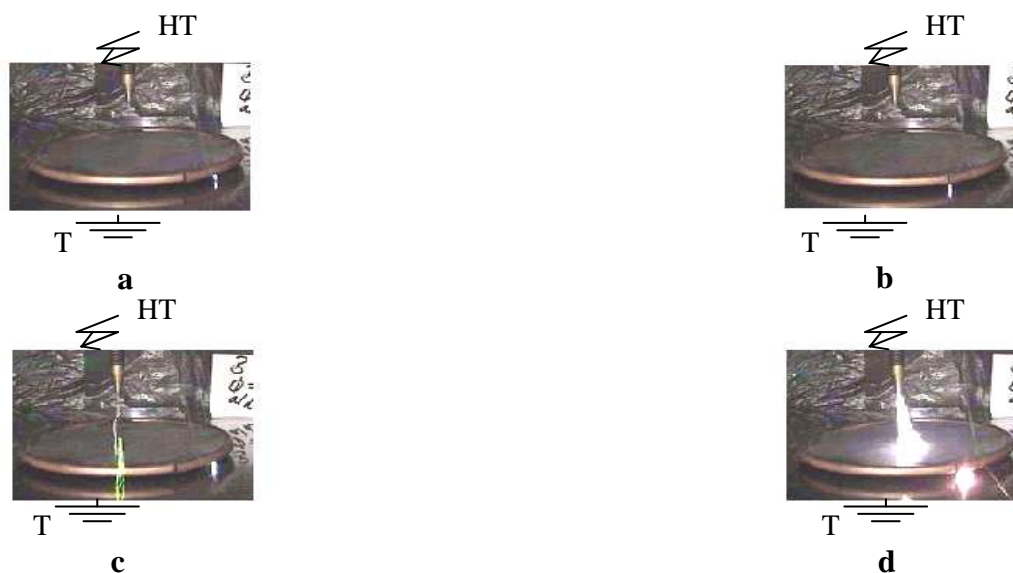
Figure.V.34 : Séquences de développement de la décharge dans l'intervalle pointe-barrière-plan pour une barrière métallique ( D_m = 15 cm, a/d = 80\% , tension alternative 50Hz)
