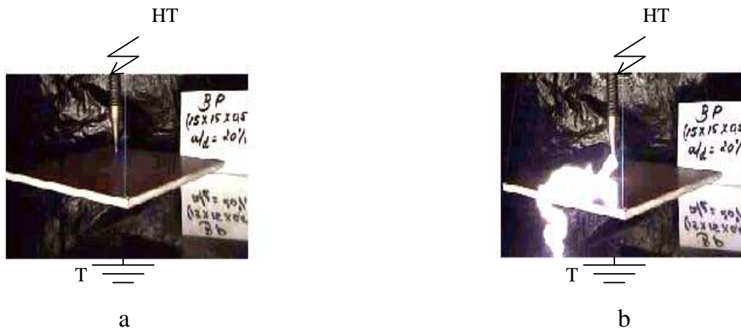
Figure.V.29 : Visualisation de la décharge dans l'intervalle pointe-barrière-plan (barrière Propre en bakélite, 2L=15\text{cm} , e=5\text{mm} et a/d=20\% , tension alternative 50Hz)
