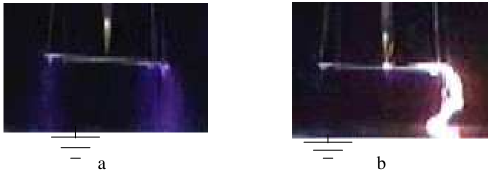
Figure.V.18 : Séquences de développement de la décharge pour une barrière en bakélite à surface polluée ( a/d = 0\% , 2L=10\text{cm} , e=2.1\text{mm} , \sigma=5.7\mu\text{S} , BpoH1f HT)
