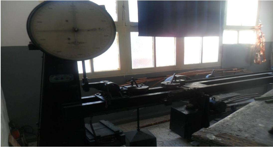
*Figure VI.4. Machine de traction à CABEL.*
