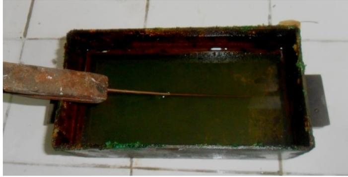
*Figure VI.19. Trempe d'une éprouvette de cuivre après traitement de recristallisation.*
