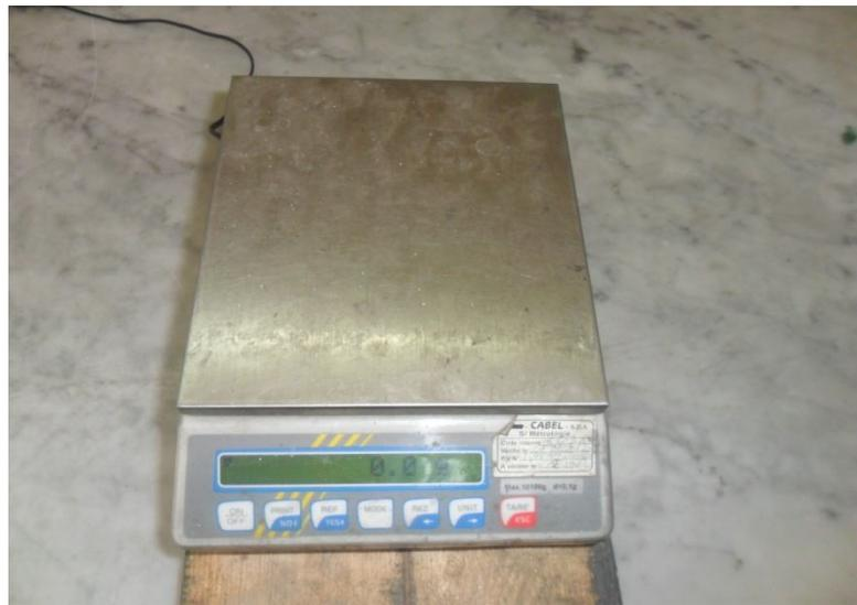
*Figure VI.3. Balance pour le calcul de la masse métrique.*
