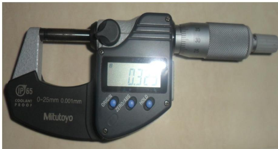
*Figure VI.2. Palmer utilisé pour la mesure du diamètre.*
