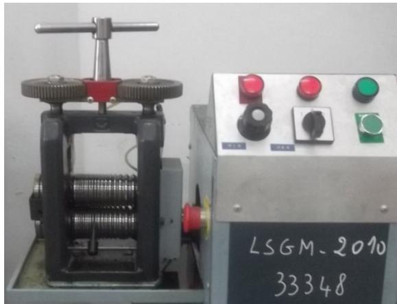
*Figure VI.11. Laminoir à double cylindre semi-automatique.*
