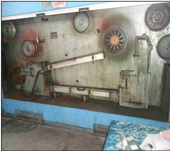
a) Four de recuit de l'ébaucheuse
