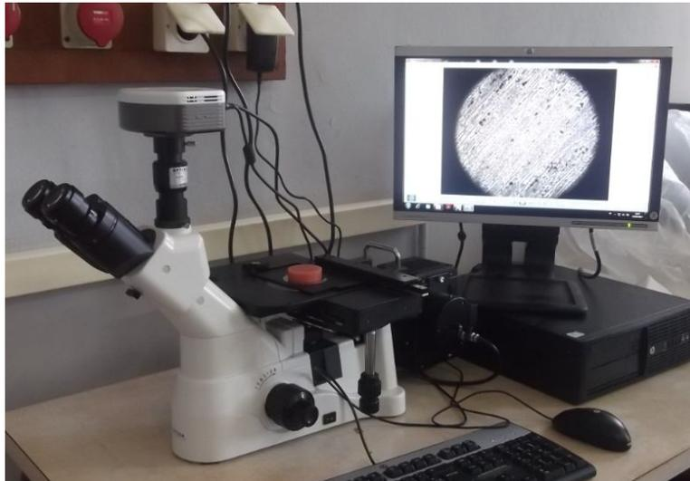
*Figure VI.27. Microscope métallographique OPTIKA M-789.*
