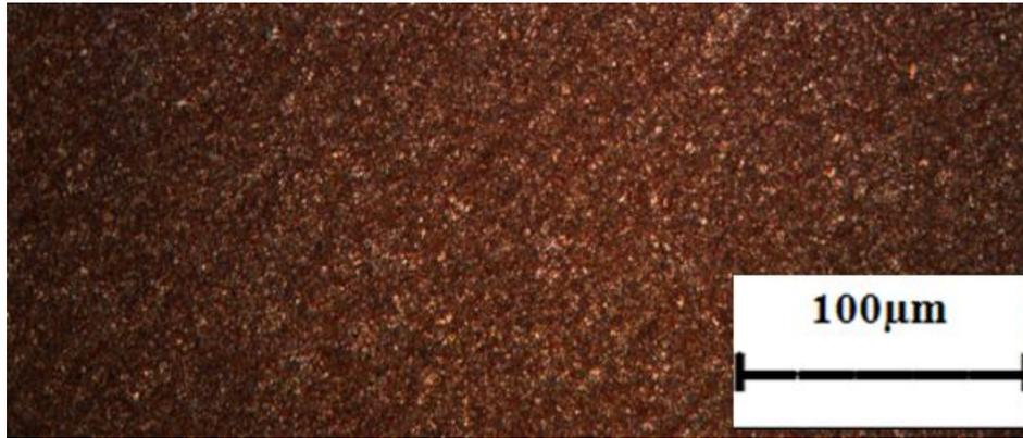
**Figure VII.13.** Recuit à 800°C avec 20 secondes de maintien.
