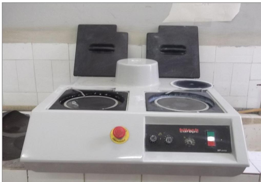
*Figure III.6 Polisseuse mécanique de type hitech europe, à vitesse maximum de 600 tr/min. (ENP, laboratoire de métallurgie).*
