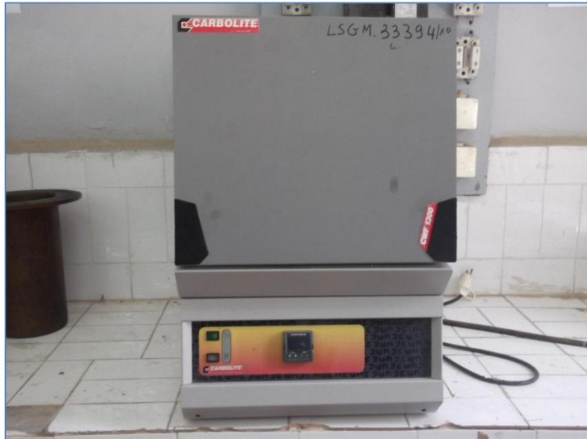
*Figure III.3 Four à résistance électrique CARBOLITE CWF 1300 (ENP, laboratoire de métallurgie).*
