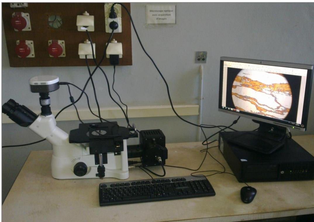
*Figure III.7 Microscope optique de type OPTIKA. (ENP, laboratoire de métallurgie).*
