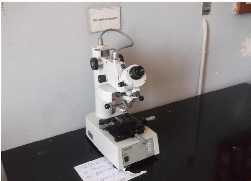
**Figure III.8** Microduromètre (Vickers). (ENP, laboratoire de métallurgie).
