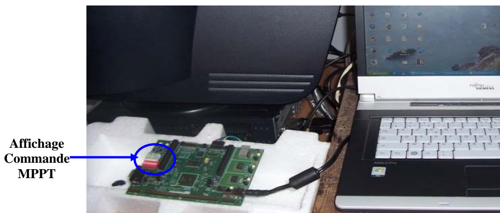
Figure V.20 : Affichage de la commande MPPT neuro-floue sur la carte VIRTEX II V2MB1000.
