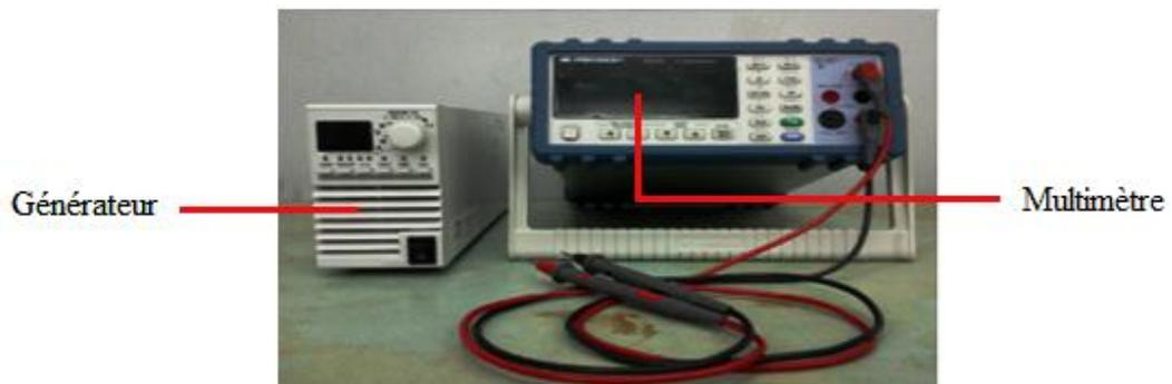
Figure V.5. Dispositif de mesure de la résistivité électrique des fils.
