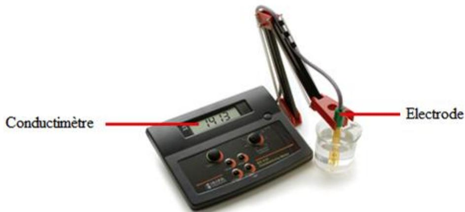
**Figure V.6.** Conductimètre de type HANNA Instruments EC215.
