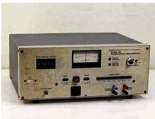
**Figure V.1.** Potentiostat de type EGG Princeton 263.
