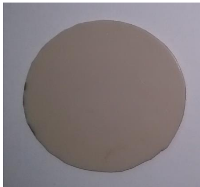
Figure 3.2 : Échantillon de PVC/B avant vieillissement
