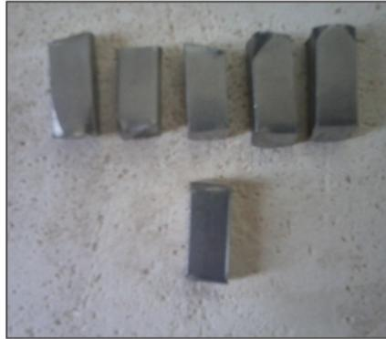
**Figure III.3-** serie d'échantillon pour le choc thermique.
