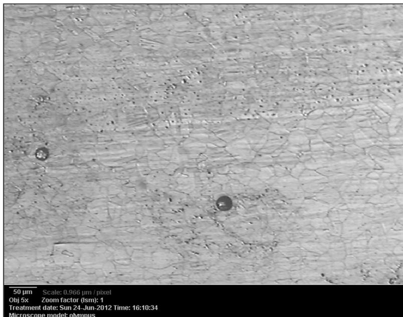
**Figure IV.14** : Structure de l'acier de 20 chocs après essai de corrosion sous contrainte.
