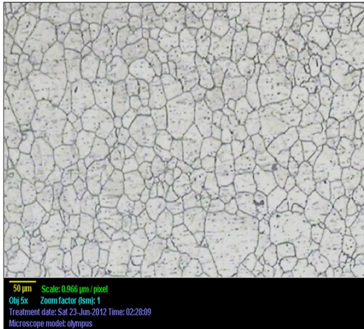
**Figure IV.1-** Microstructure de l'acier 316L après traitement d'hypertrempe.
