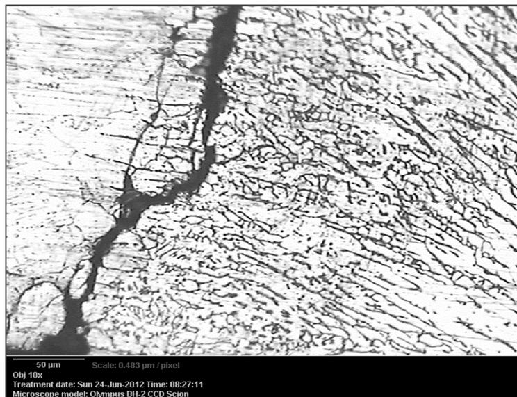
**Figure IV. 16 -** fissuration dans la zone de liaison.
