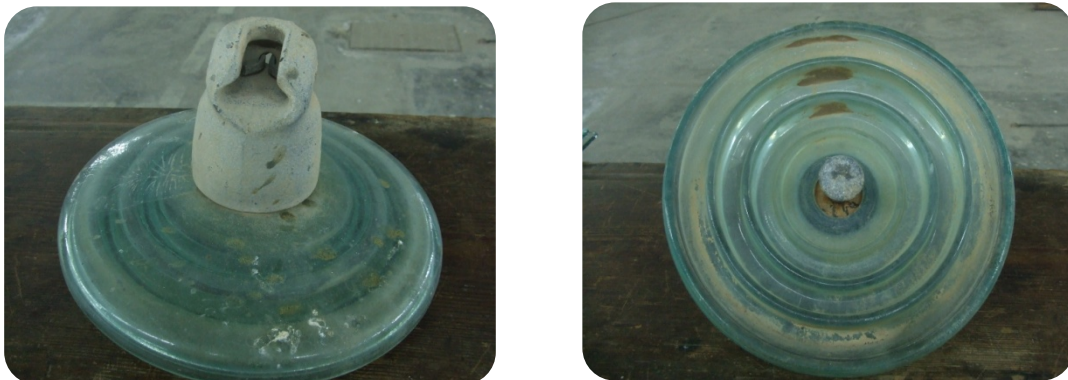
Fig.IV.4 : Isolateur N°1 (coté terre de la chaîne 220 kV).
