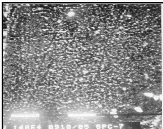
**Figure (III.22) : Observation au MEB du dépôt de PMMA dans la DMF par méthode de spin coating.**
