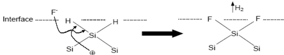
**Schéma (I.3) : Mécanisme d'attaque de la couche de passivation Si-H par les ions  $F^-$  [23].**
