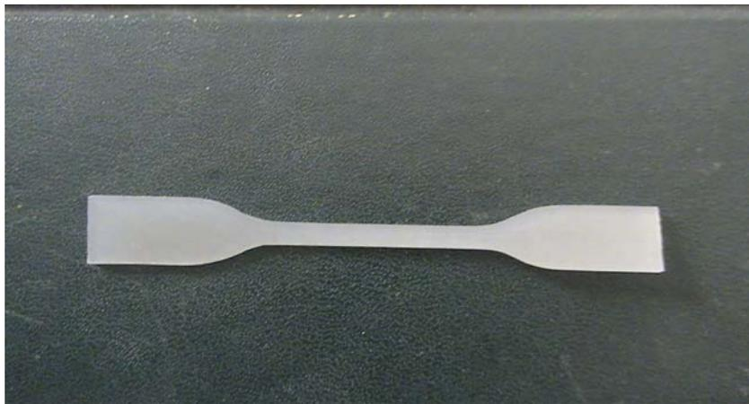
**Figure III.9.** Éprouvette sous forme d'haltère.
