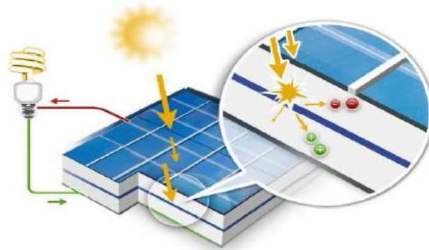
Figure I. 3 Principe de fonctionnement de la cellule PV
