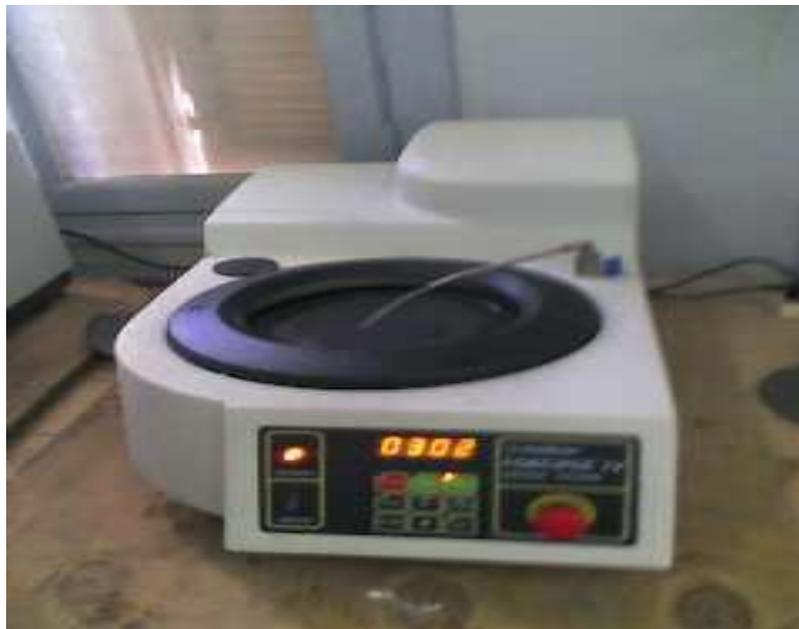
Figure IV.6: Polisseuse mécanique type Forcipol, à vitesse maximum de 600 tr/min. (ENP, laboratoire de métallurgie).
