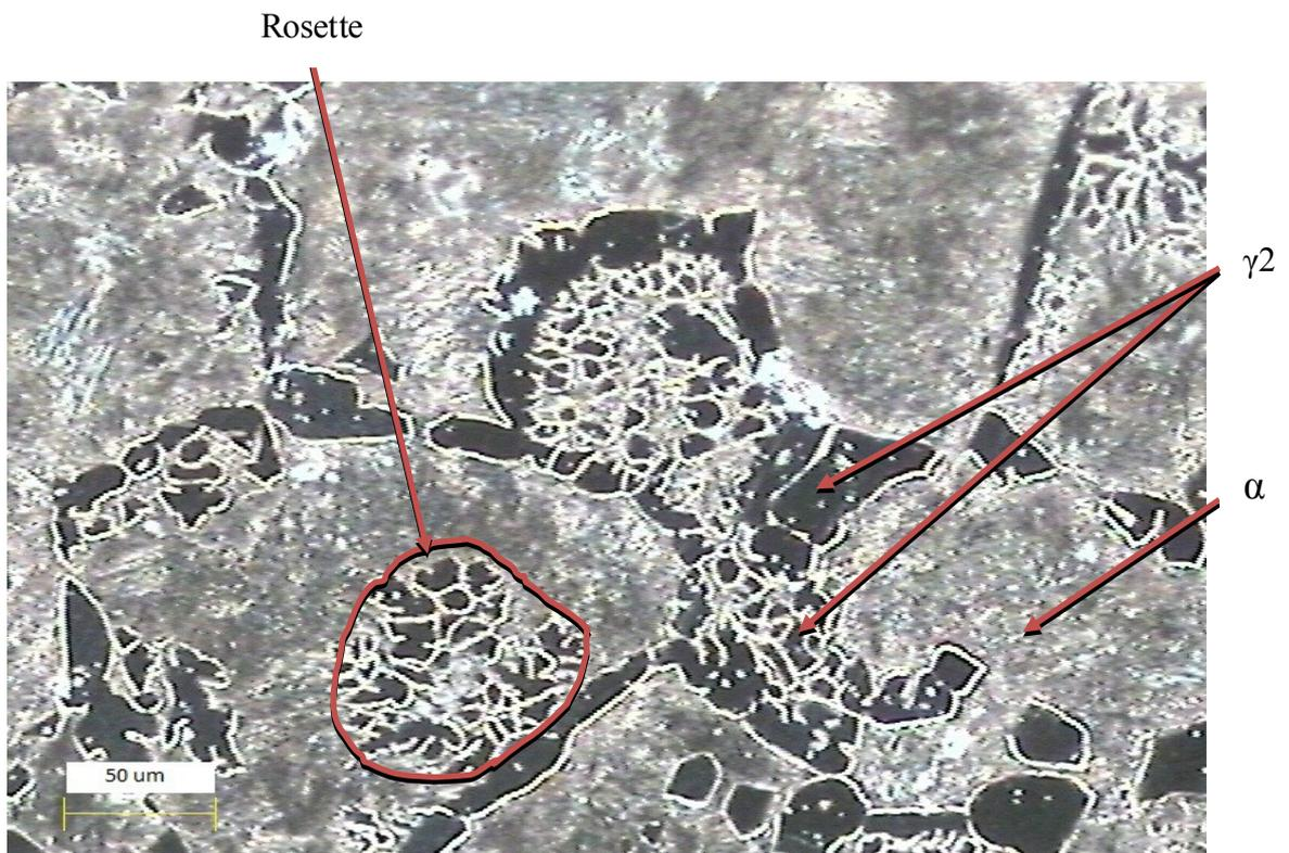
Figure V.4 micrographie optique de la structure à l'équilibre.
