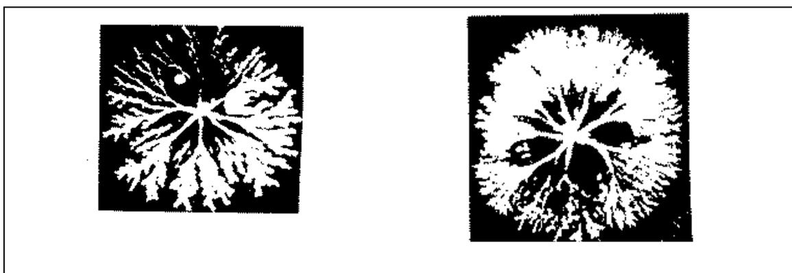
**Figure II.1:** décharges à l'interface liquide/solide dans un système pointe-plan [14]
