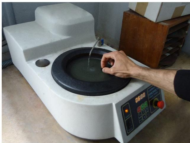
**Figure IV. 1.** Polisseuse utilisée.
