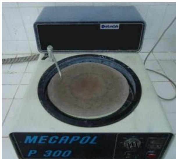
**Figure IV. 2.** Polisseuse de finition utilisée de type ‘ MECAPOL P300 ‘.
