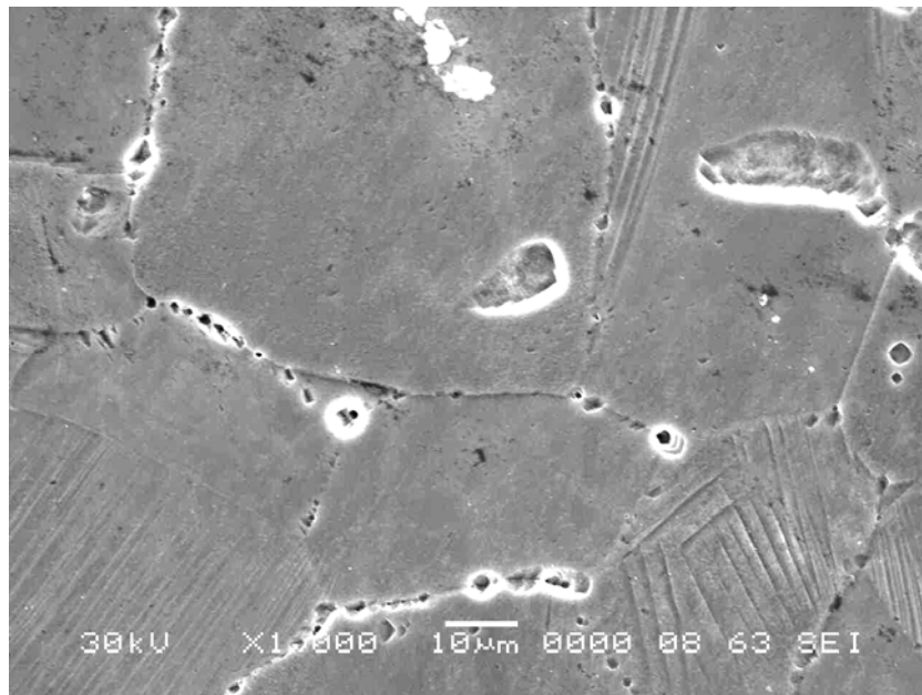
Figure V.20 – Micrographie MEB, Forme de la ZAT après 400 cycles (G=1000) Essai 360-98°C.
