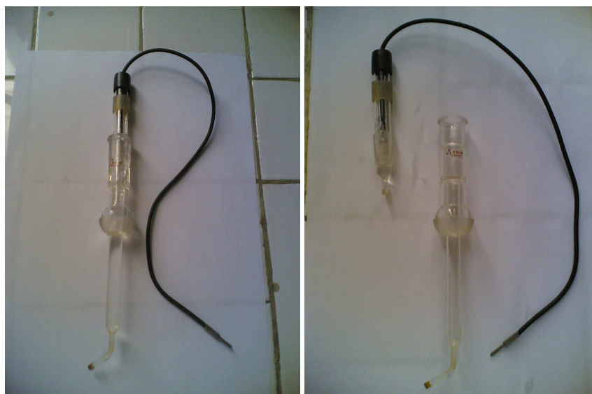
Figure 21: Electrode de référence au calomel saturé (ECS) : électrode et capillaire de Luggin.
