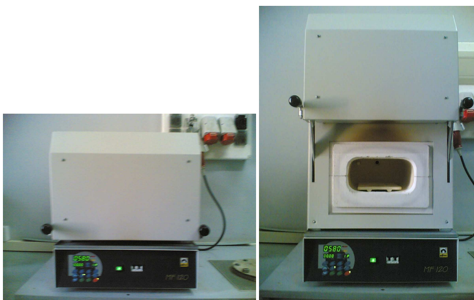
Figure 15: Photographie du four à moufle type Nüve MF 120 utilisé pour les traitements thermiques.
