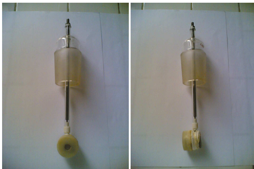
Figure 20: Photographie de l'électrode de travail : échantillon et porte échantillon (vue de face et de côté).
