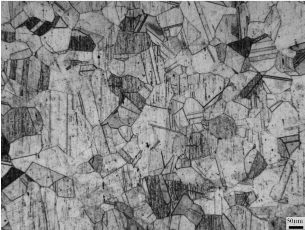
Figure 26: Photographie de la microstructure du matériau 2 après polissage mécanique.
