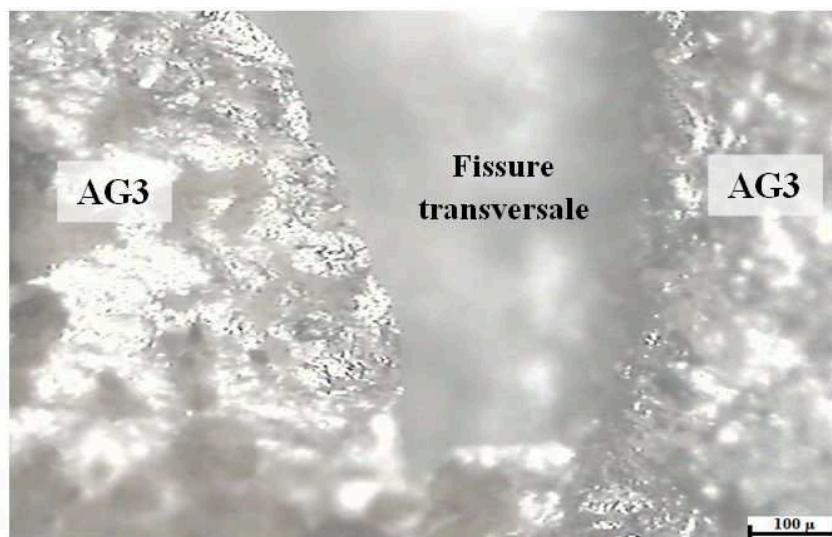
Figure V-24: Fissure transversale observée sous microscope optique.
