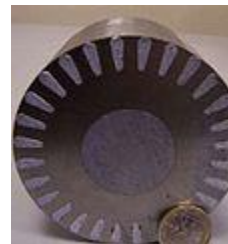
-c- coupe d'un rotor à cage à encoches profondes
