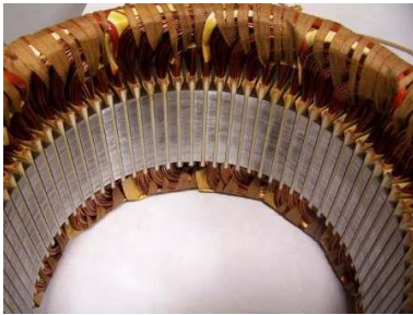
Figure I. 1 : Stator d'une machine triphasée
