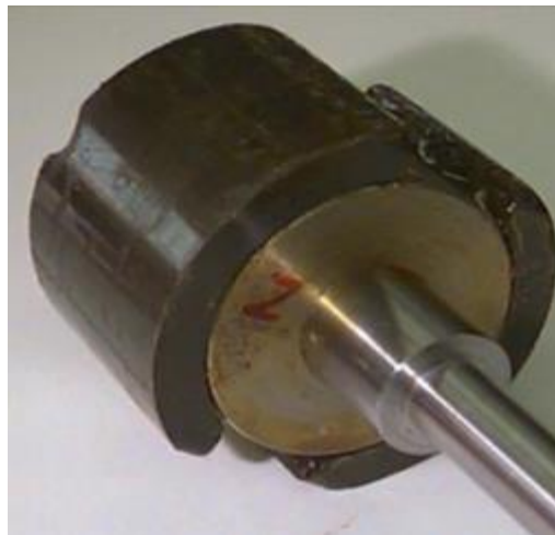
Figure I. 4 : Rotor de la machine synchrone à aimants
