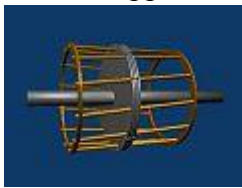
-a- structure d'un rotor en cage d'écureuil
