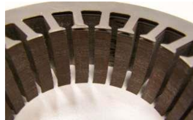
Figure I. 2 : Stator feuilleté sans les bobinages
