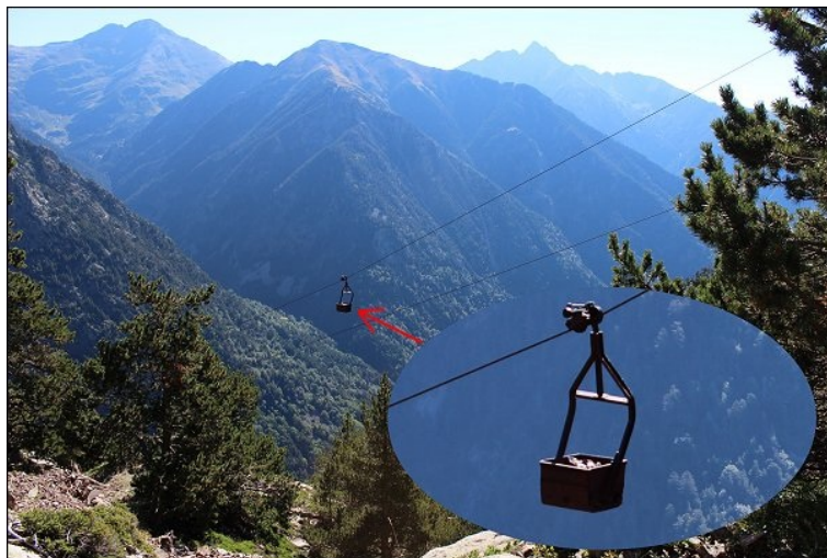
Figure III.5: Utilisation de Téléphérique dans le transport de la roche minière.
