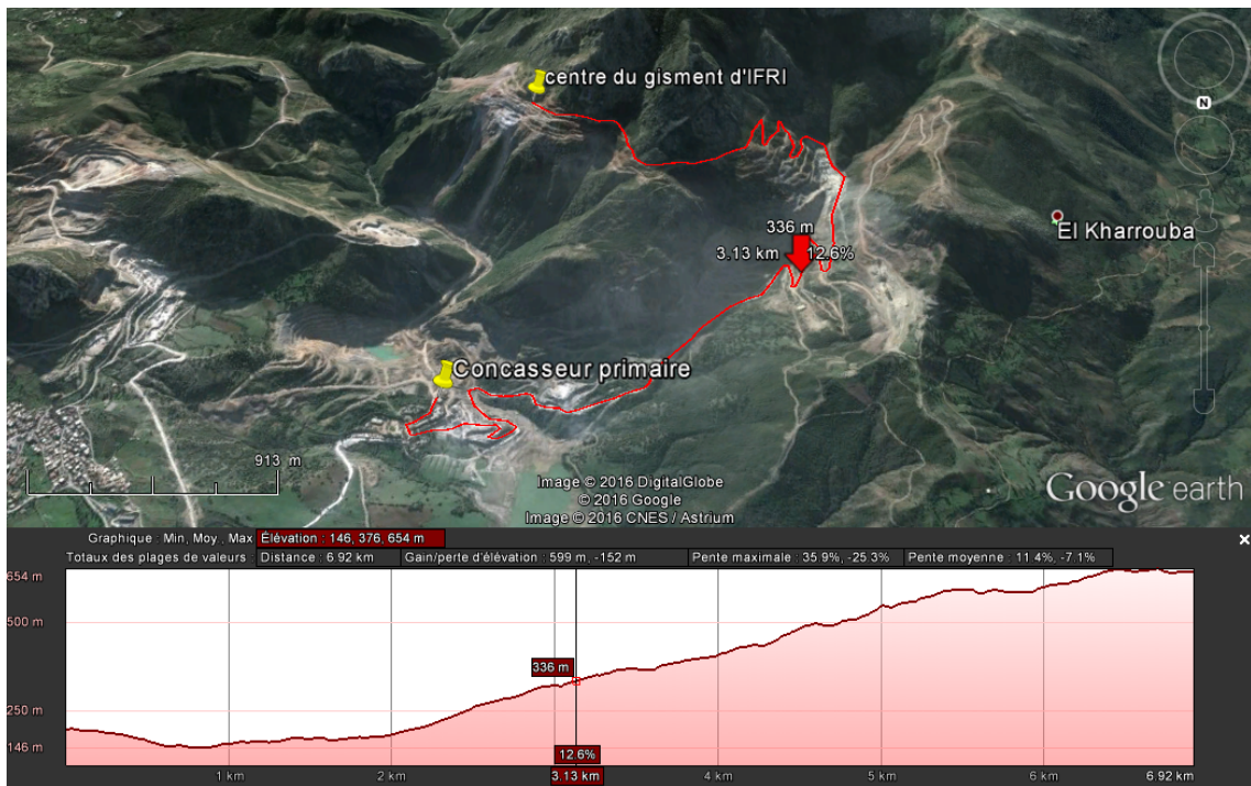
Figure V.8: Représentation de la piste d'accès au gisement d'IFRI avec la variation des pentes
