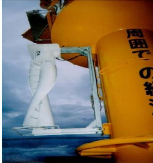
**Fig.1.2 Petite éolienne à axe vertical**
