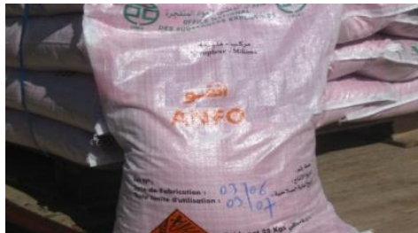
Fig 1.2. Explosifs pulvérulents sans NGL de type ANFO [05]
