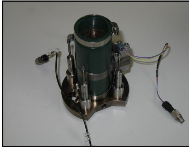
**Fig. III.11 :** Système "LVDT"
