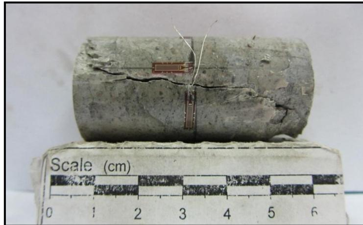
**Fig. III.19 :** Clivage de la rupture d'un échantillon en compression simple
