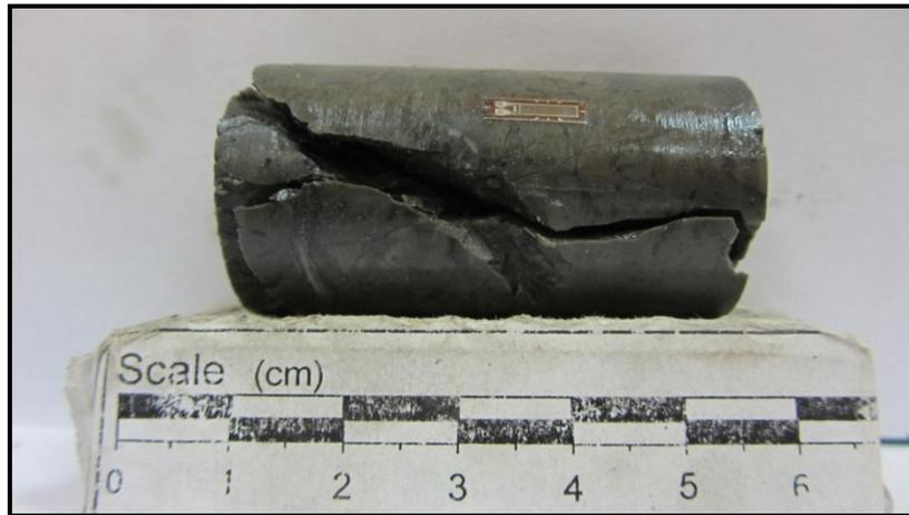
**Fig. III.26 :** Clivage de la rupture d'un échantillon en essai triaxial
