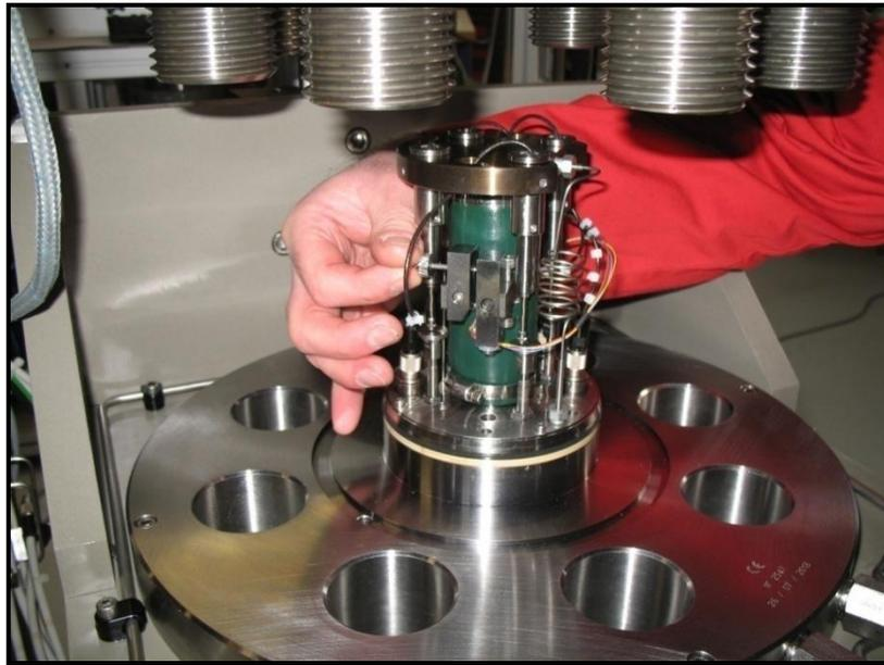
**Fig. III.14 :** Montage de l'échantillon dans la cellule.
