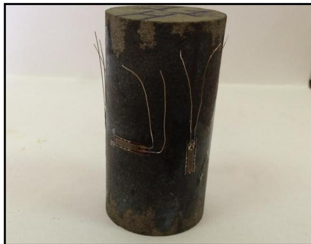
**Fig. III.10** : Jauges extensométriques
