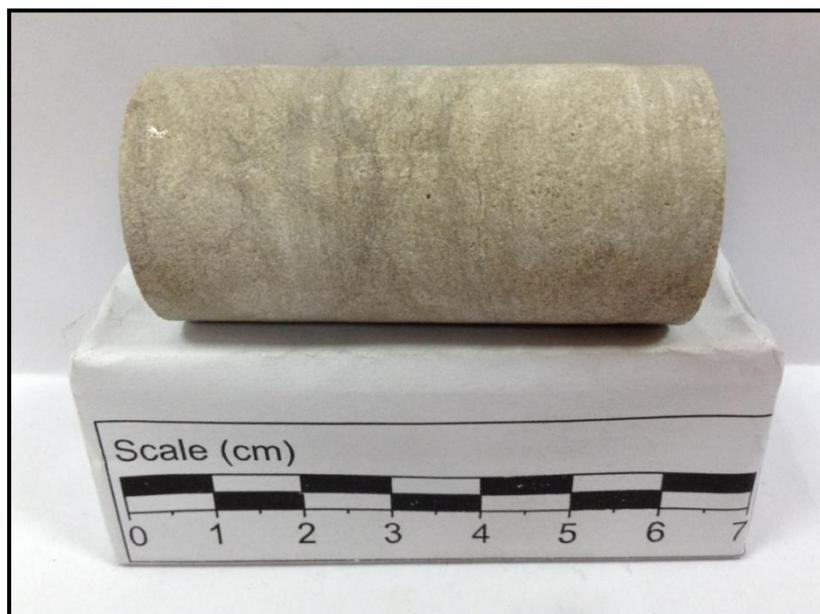
**Fig. III.8 :** Echantillon cylindrique (Plug) de carbonate.
