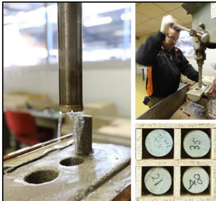
Fig. III.7 : Prélèvement des échantillons de carotte (Plugging).
