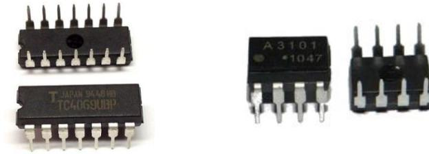
**Figure IV. 48 :** *L'inverseur Toshiba 4069 et l'optocoupleur HCPL 3101.*
