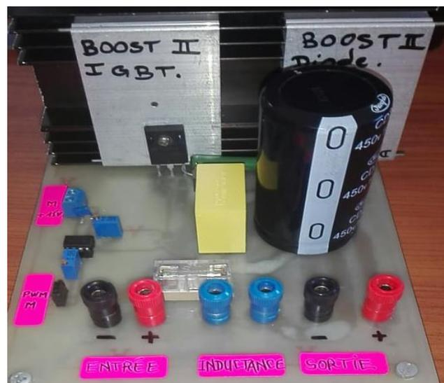
Figure IV. 20 : Schéma global du hacheur BOOST réalisé.
