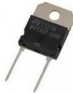
**Figure IV. 10 :** Diode du type *BYT30P-1000*.
