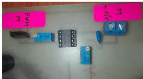
**Figure IV. 14 :** Circuit de commande du hacheur Boost.
