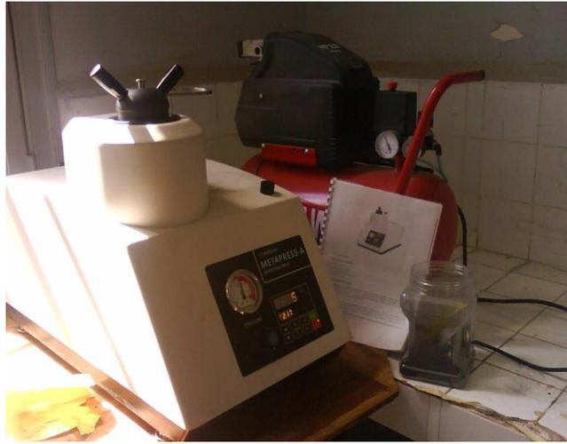
**Figure 28 :** Photo réelle d'une enrobeuse à chaud
