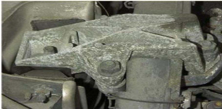
**Figure 14 :** Corrosion d'un supporte moteur en alliage d'aluminium [5].
