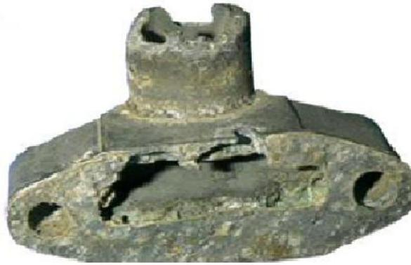
**Figure 19 :** Corrosion générale d'une pièce en alliage d'aluminium [5].
