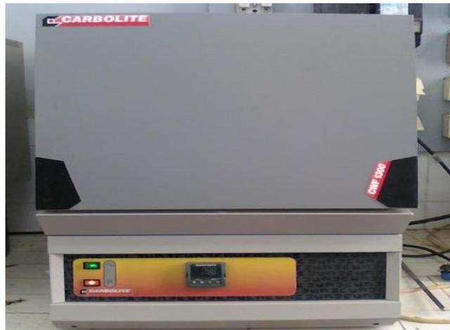
**Figure 22** : Photo réelle d'un Four à résistance.
