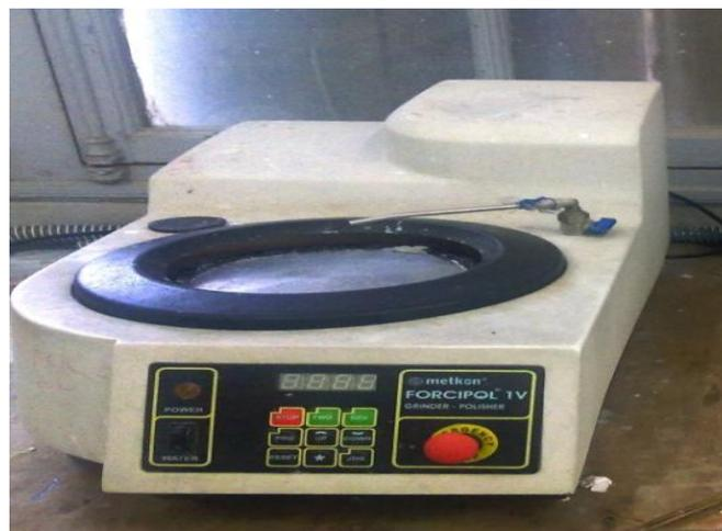
**Figure 23**: Photo réelle d'une polisseuse de type FOCIPOLE.
