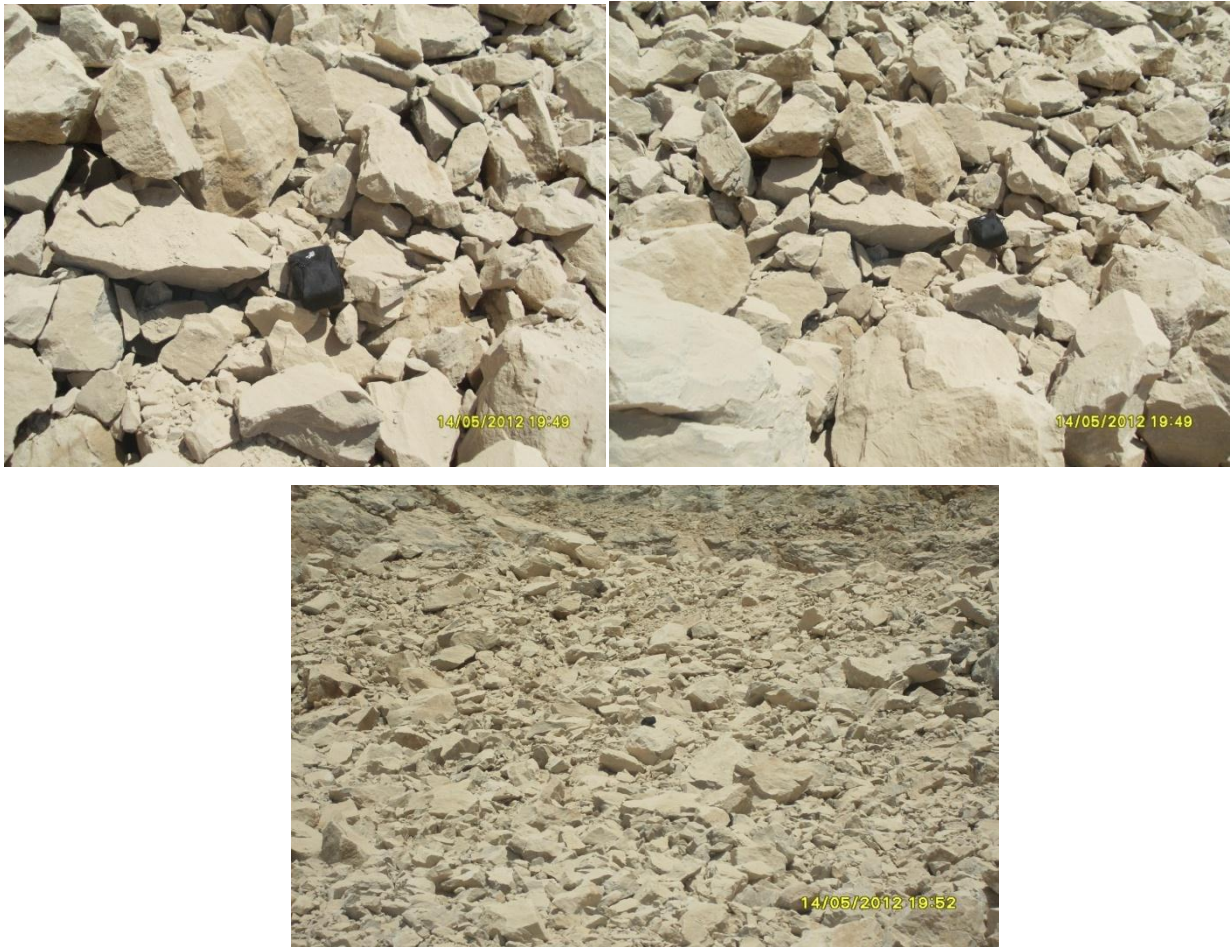
Fig. III.2 : Blocométrie obtenue après le tir du 14-5-2012 à Keddara.
