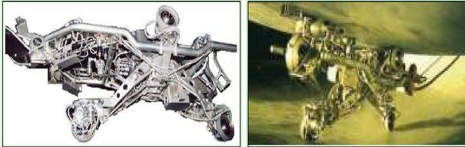
Figure 2.12. Robot MIR 'Machine d'inspection des réacteurs rapides'
