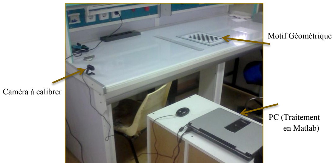
Figure 3.2. Banc de calibration géométrique de la Caméra
