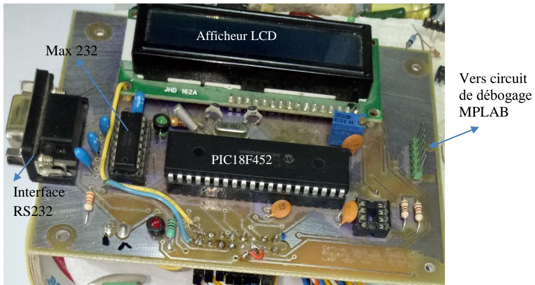
Figure 6.28. Carte de commande à base du pic 18F452 et périphériques
