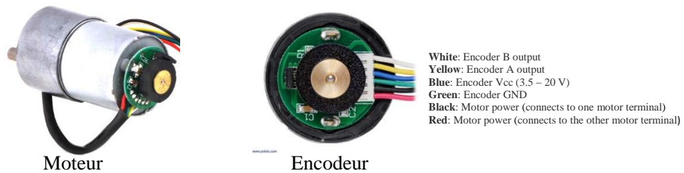
Figure 6.5. Schématisation Moteur à courant continu et son encodeur incrémental avec 64 CPR
