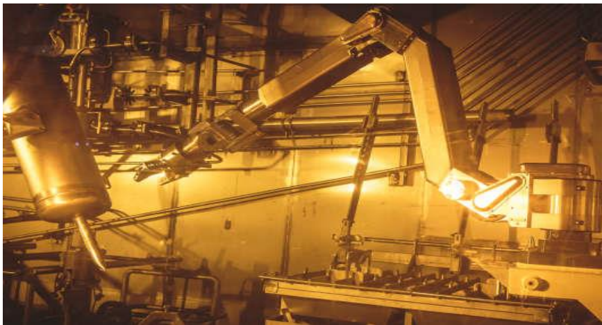
Figure 2.15. Le bras Maestro au travail dans un des ateliers radioactifs de Marcoule (Gard en France)
