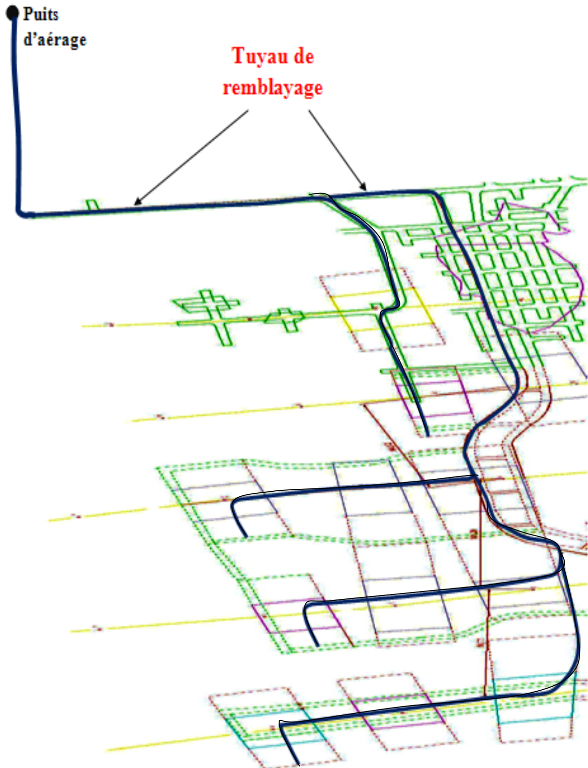
Figure IV.14: Parcours du conduit de remblayage.
