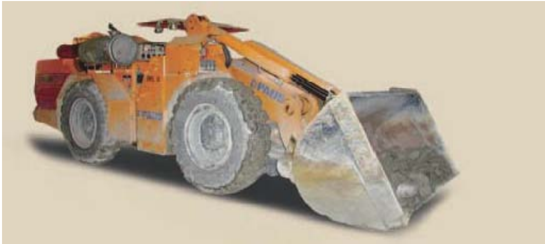
Figure IV.17: Chargeur Type CTX4 de capacité de godet de 4 tonnes.
