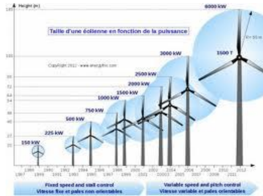
Figure II.20 : Evolution de la taille et de la puissance des éoliennes. [34]
