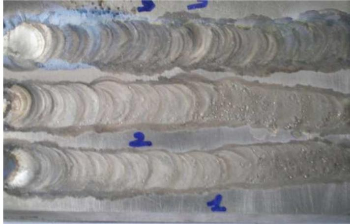
**Figure 1.** Influence de la vitesse du soudage sur la largeur et la pénétration.
