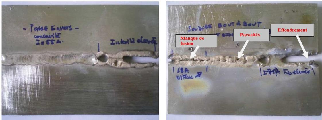
*Figure 3. Présentation des soudures endroit et envers.*
