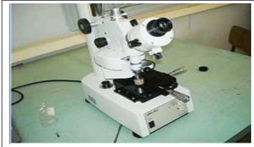
*Figure 21. Micro-duromètre SHIMATZU HMV-M3.*
