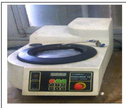
**Figure 12.** La polisseuse utilisée de type FOCIPOLE.
