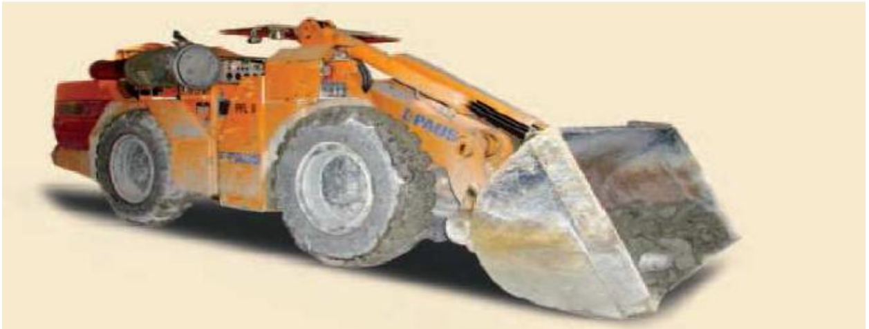
Figure IV .09 : Chargeur Type CTX4 de capacité de godet de 4 tonnes.
