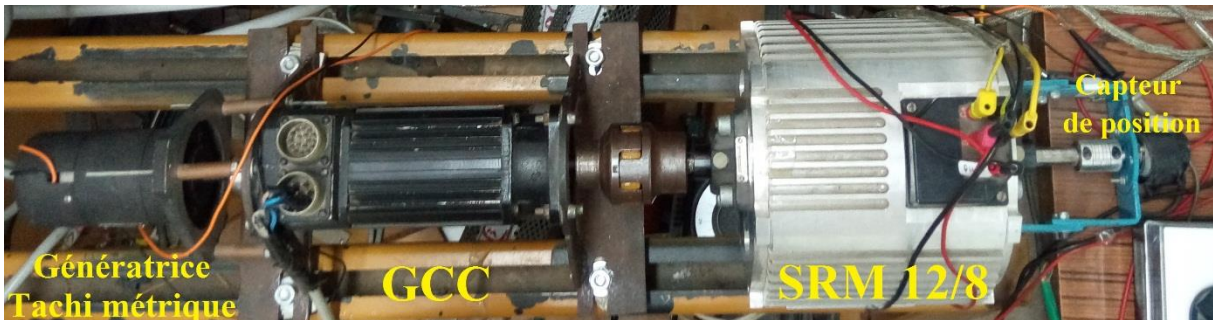
Figure 1.23 : SRM 12/8 couplé à une GCC et Génératrice Tachymétrique
