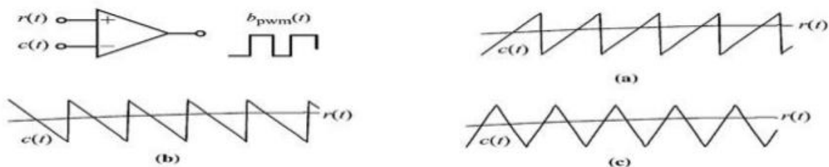
Figure 1.2 Modulation de largeur d'impulsion, a) Porteuse en dent de scie, b) Porteuse en dent de scie inversée, c) Porteuse triangulaire [1].
