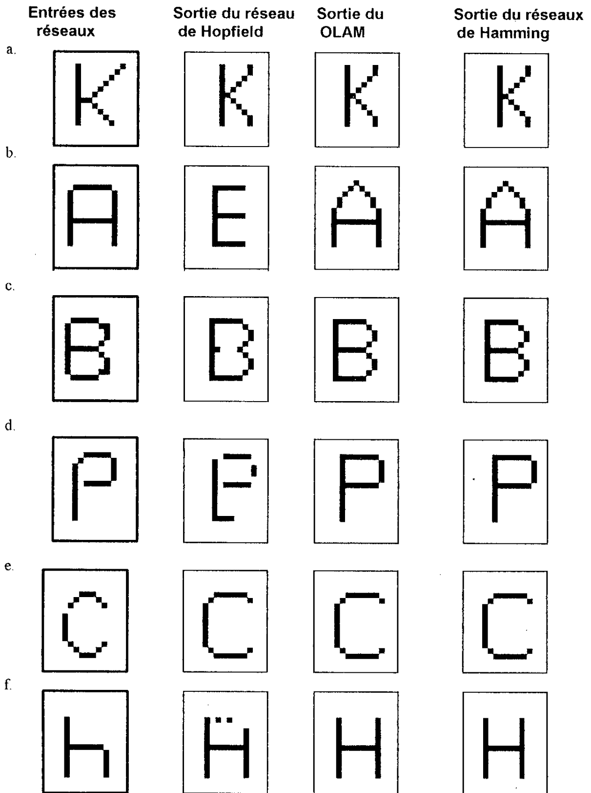
Fig III.3 Réponse des réseaux pour des entrées de forme différente par rapport aux prototypes d'entraînement.
