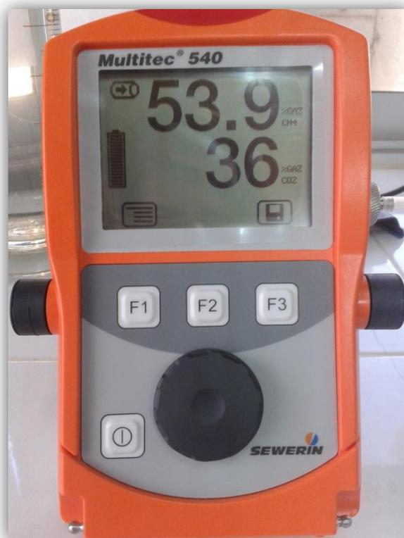
**Figure 31: Analyse du gaz produit lors de la 3ème co-digestion**
