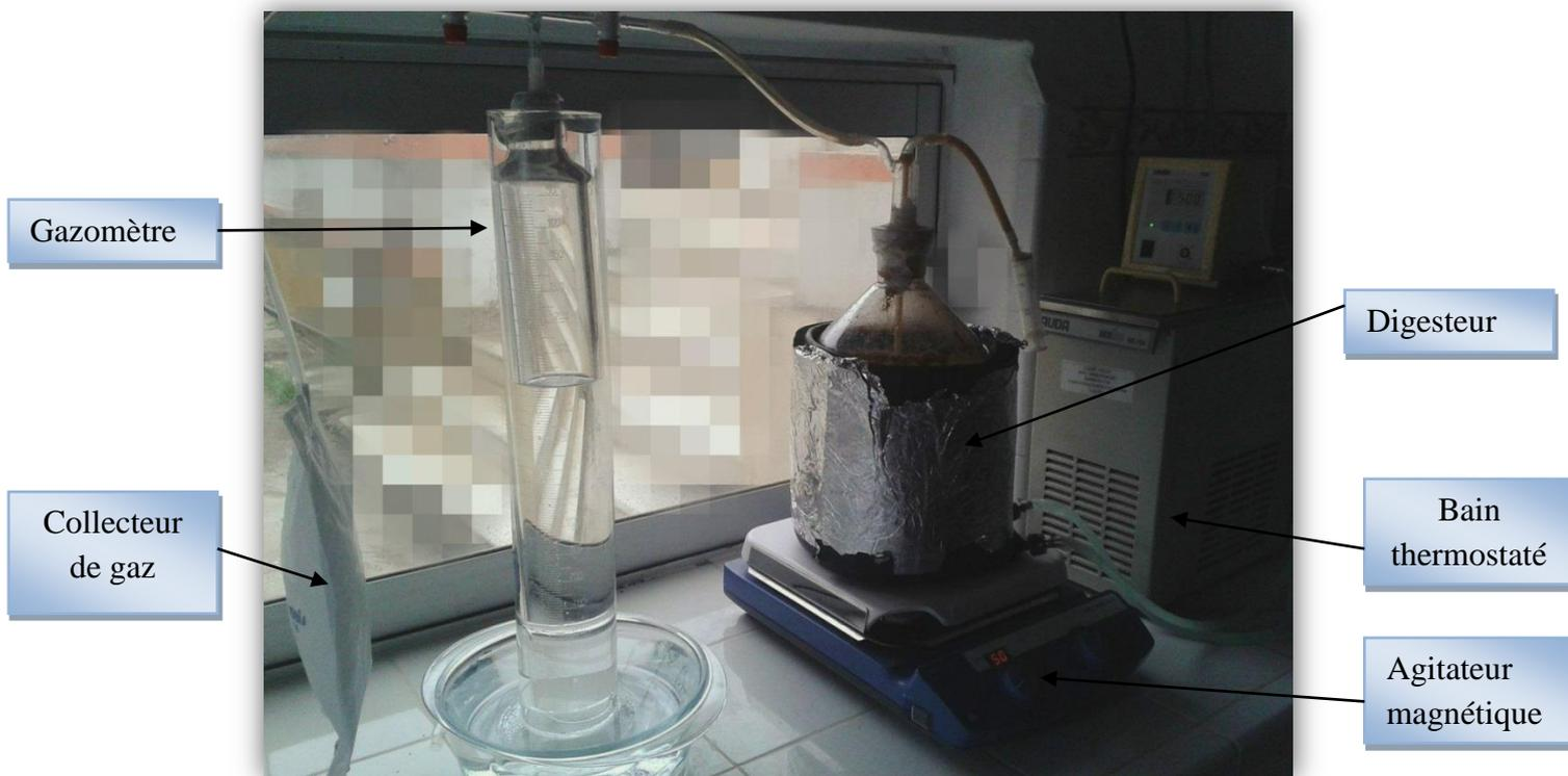
Figure 6 : Dispositif expérimental de la 2<sup>ème</sup> co-digestion
