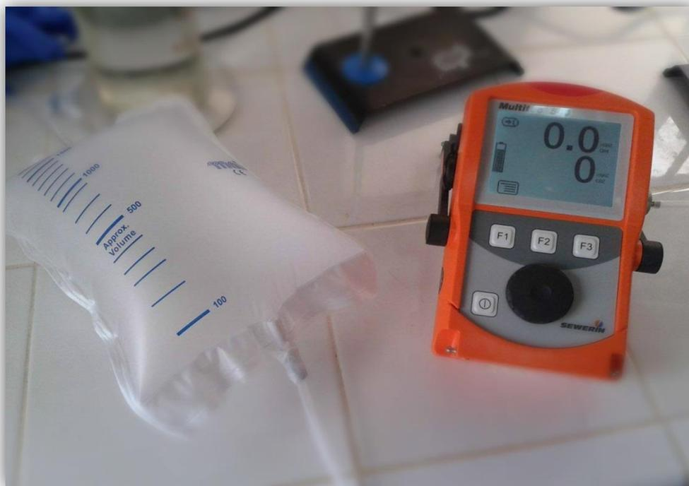
**Figure 30: Analyseur de biogaz donnant la composition du méthane et dioxyde de carbone**
