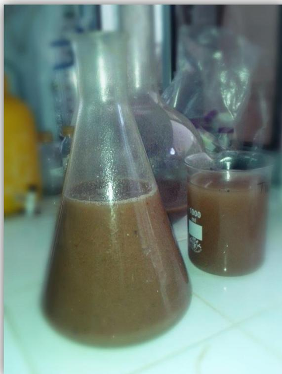
**Figure 28: Echantillon des boues biologiques issues de la STEP de la laiterie**
