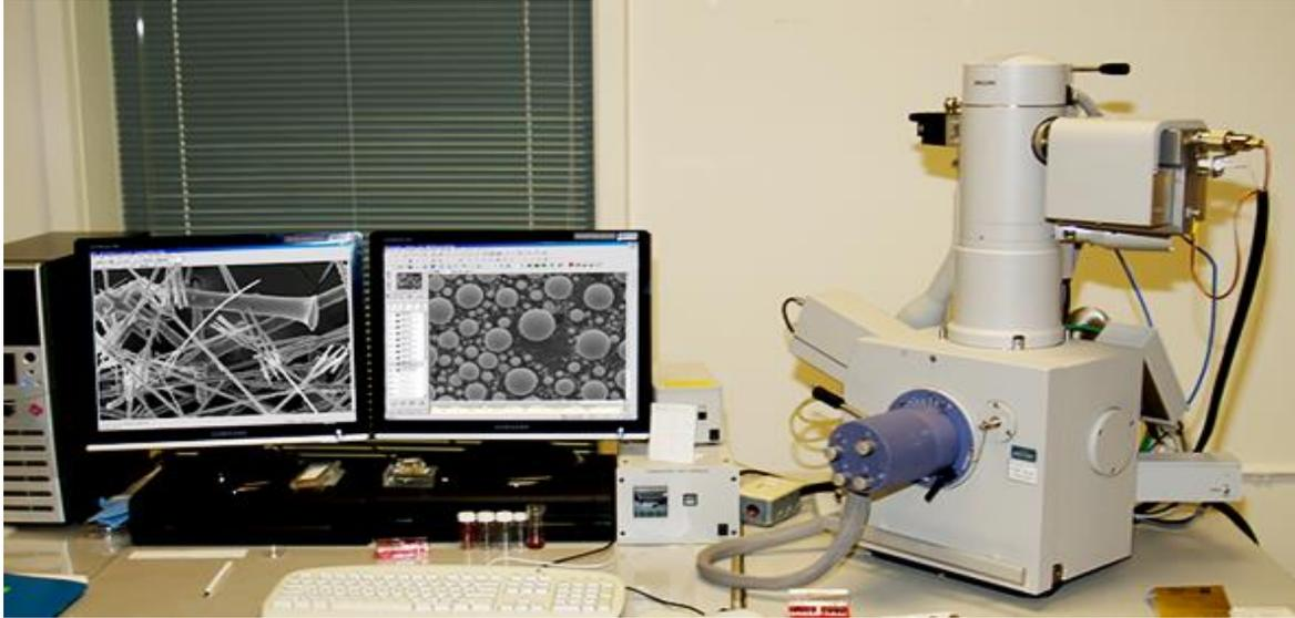
**Figure III.9 : MEB de type philips XL30**
