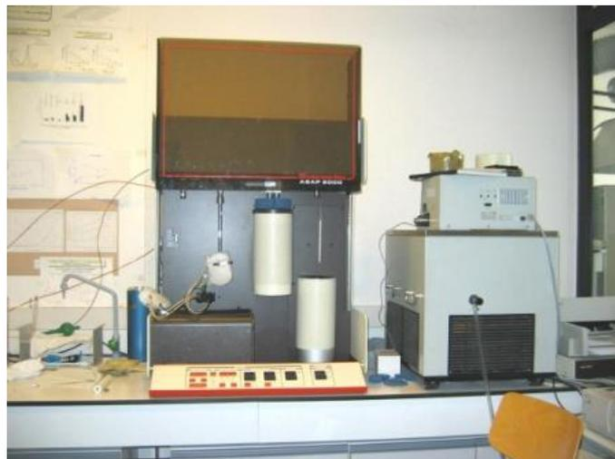
**Figure III.8 : L'appareil micromeritics ASAP 2010**
