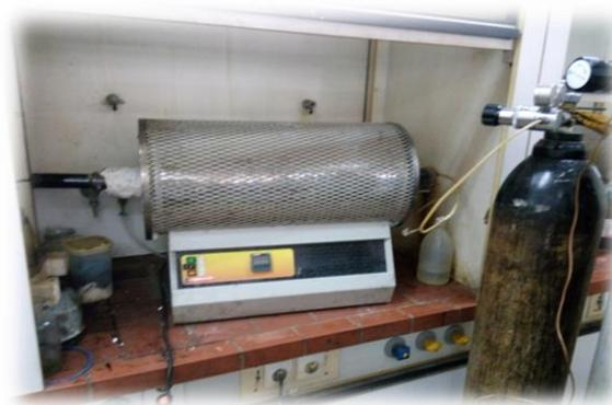
Figure III.6: Montage utilisé pour la carbonisation
