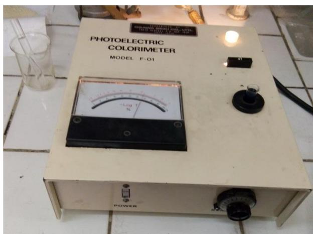
**Figure III.11 : colorimètre photoélectrique utilisé pour l'analyse**
