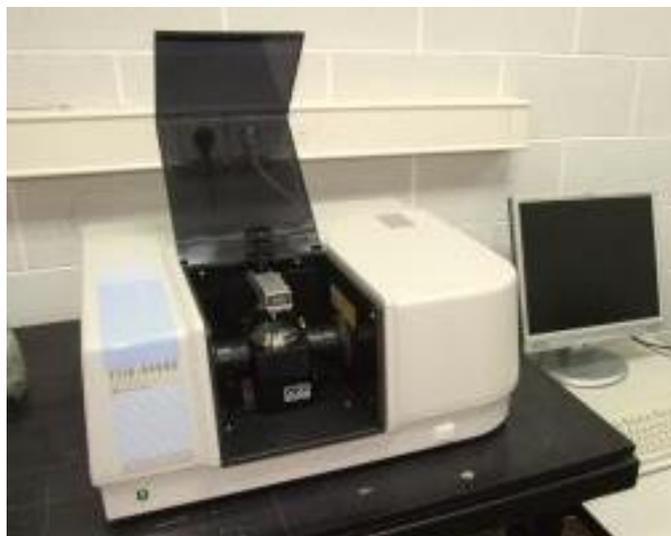
**Figure III.10: Spectromètre d'absorption FTIR "SHIMADZU type 8400S"**
